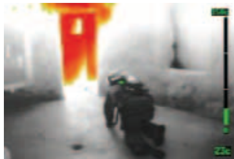
Modo Alta Sensibilità: Notare le numerose differenze di temperatura
