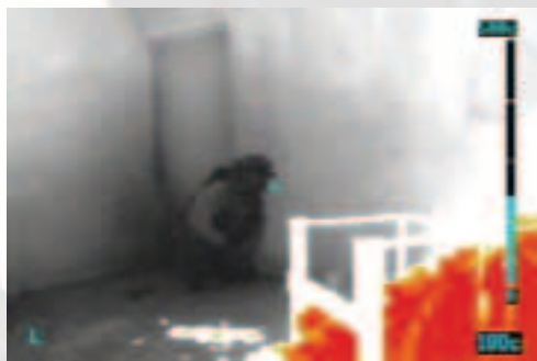
Modo Bassa Sensibilità: Notare la separazione tra muro e pavimento
